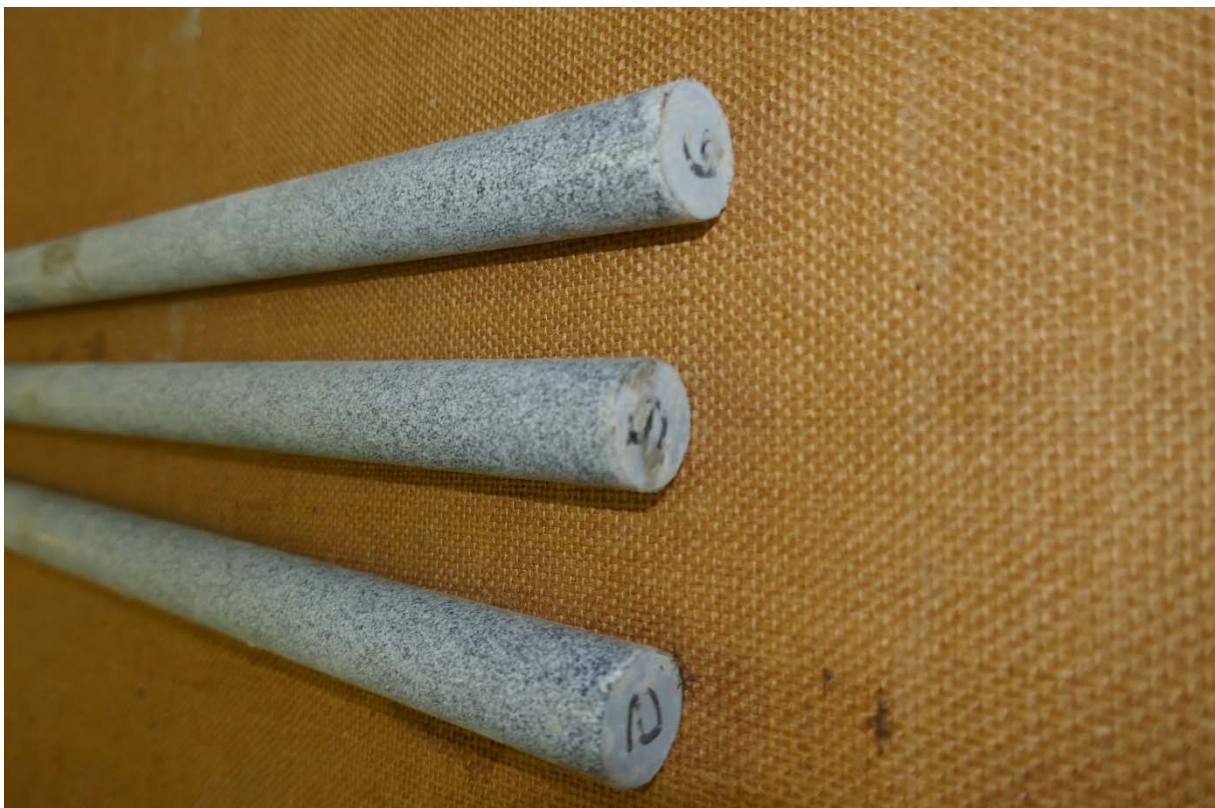
Bild 2: Ansicht der weiteren Mantelflächen der Dübel nach der Prüfung, ohne Beschädigung der Beschichtung.
