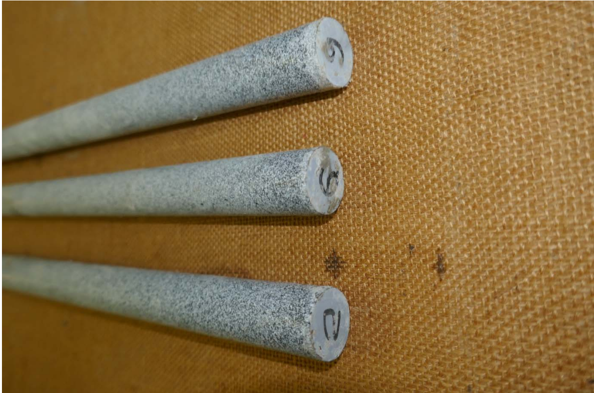
Bild 1: Geprüfte Dübel Nr. 2, Nr. 6 und Nr. 9 ohne Beschädigung oder Ablösung der Beschichtung.
