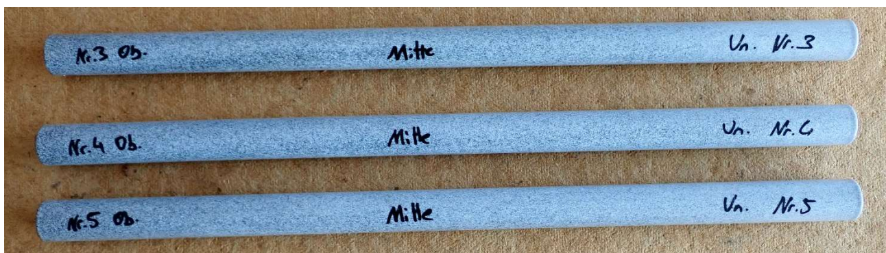
Abbildung 1: Kunststoffbeschichtung der untersuchten Dübel vor der Prüfung.
