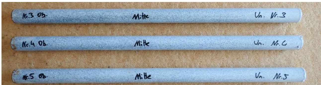
Abbildung 3: Die betrachteten Mantelflächen der Dübel zeigen nach 240 Stunden unter Salznebel keine Rostmarken.
