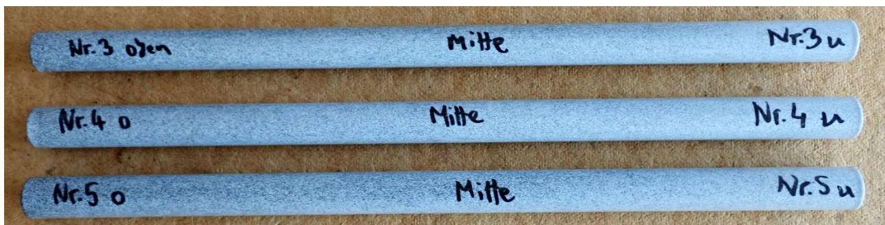
Abbildung 2: Rückseitige Mantelflächen der untersuchten Dübel vor der Prüfung.
