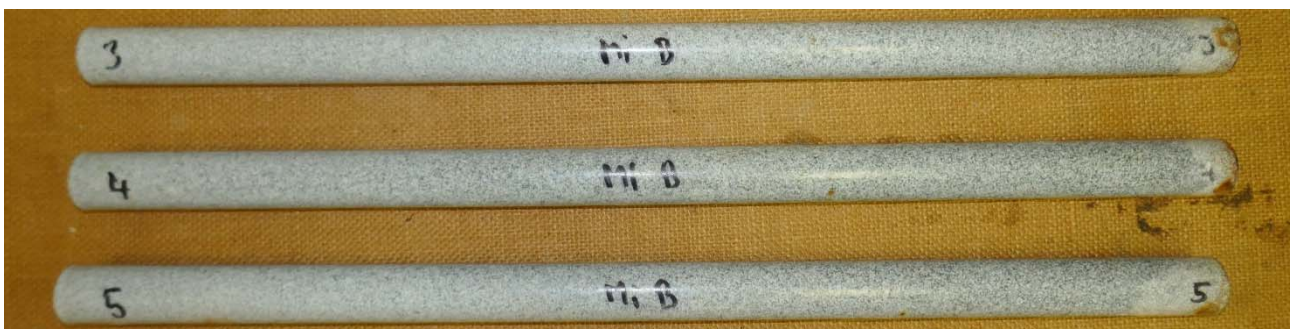
Abbildung 4: Rückseitige Mantelfläche der Dübel nach 240 Stunden unter Salznebel ohne jegliche Korrosion im betrachteten Bereich der Beschichtung.
