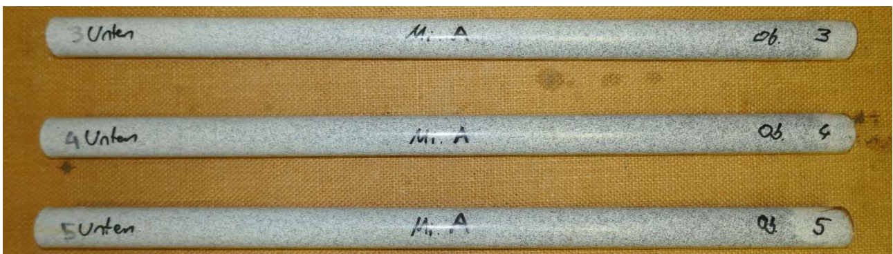
Abbildung 3: Die betrachteten Mantelflächen der Dübel zeigen nach 240 Stunden unter Salznebel keine Rostmarken.
