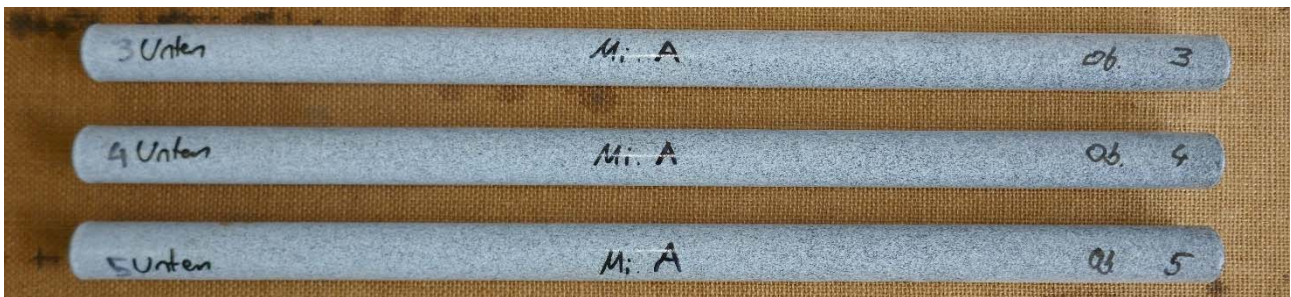
Abbildung 1: Kunststoffbeschichtung der untersuchten Dübel vor der Prüfung.
