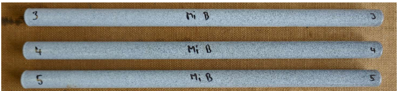
Abbildung 2: Rückseitige Mantelflächen der untersuchten Dübel vor der Prüfung.
