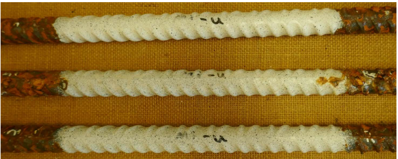
Abbildung 8: Rückseitige Ansicht der Anker im Bereich der betrachteten Beschichtung (ohne Korrosion) nach 240 Stunden Salznebel.
