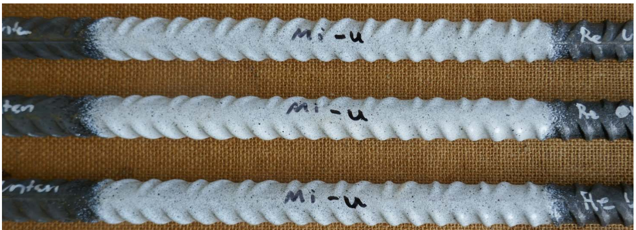
Abbildung 6: Rückseitige Ansicht der Anker im Bereich der Beschichtung vor der Prüfung.
