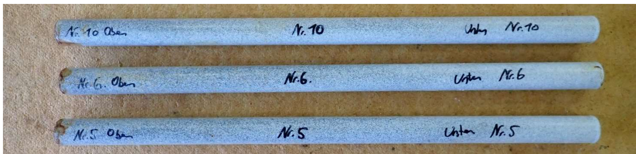
Abbildung 3: Die betrachteten Mantelflächen der Dübel zeigen nach 240 Stunden unter Salznebel keine Rostmarken.
