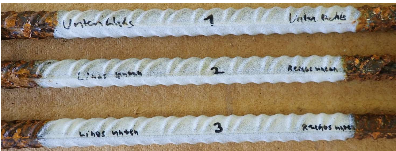
Abbildung 8: Rückseitige Ansicht der Anker im Bereich der betrachteten Beschichtung (ohne Korrosion) nach 240 Stunden Salznebel.
