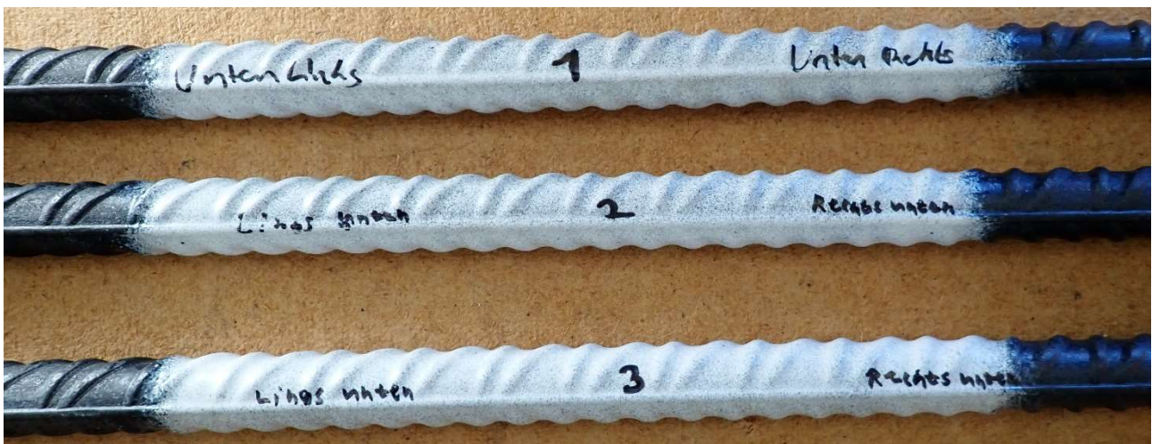
Abbildung 6: Rückseitige Ansicht der Anker im Bereich der Beschichtung vor der Prüfung.
