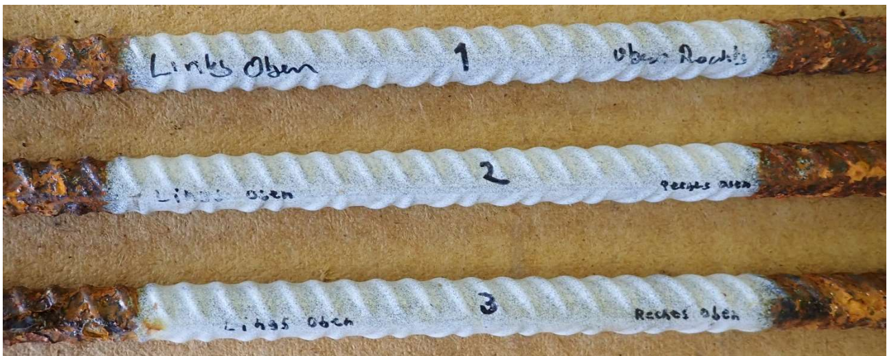
Abbildung 7: Ansicht der Anker im Bereich der betrachteten Beschichtung (ohne Korrosion) nach 240 Stunden Salznebel.
