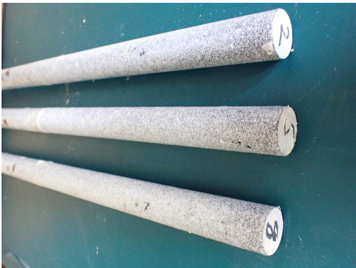
Bild 2: Ansicht der weiteren Mantelflächen der Dübel nach der Prüfung, ohne Beschädigung der Beschichtung.
