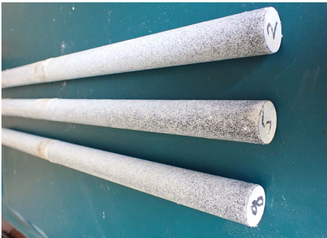
Bild 1: Geprüfte Dübel Nr. 2, Nr. 5 und Nr. 8 ohne Beschädigung oder Ablösung der Beschichtung.
