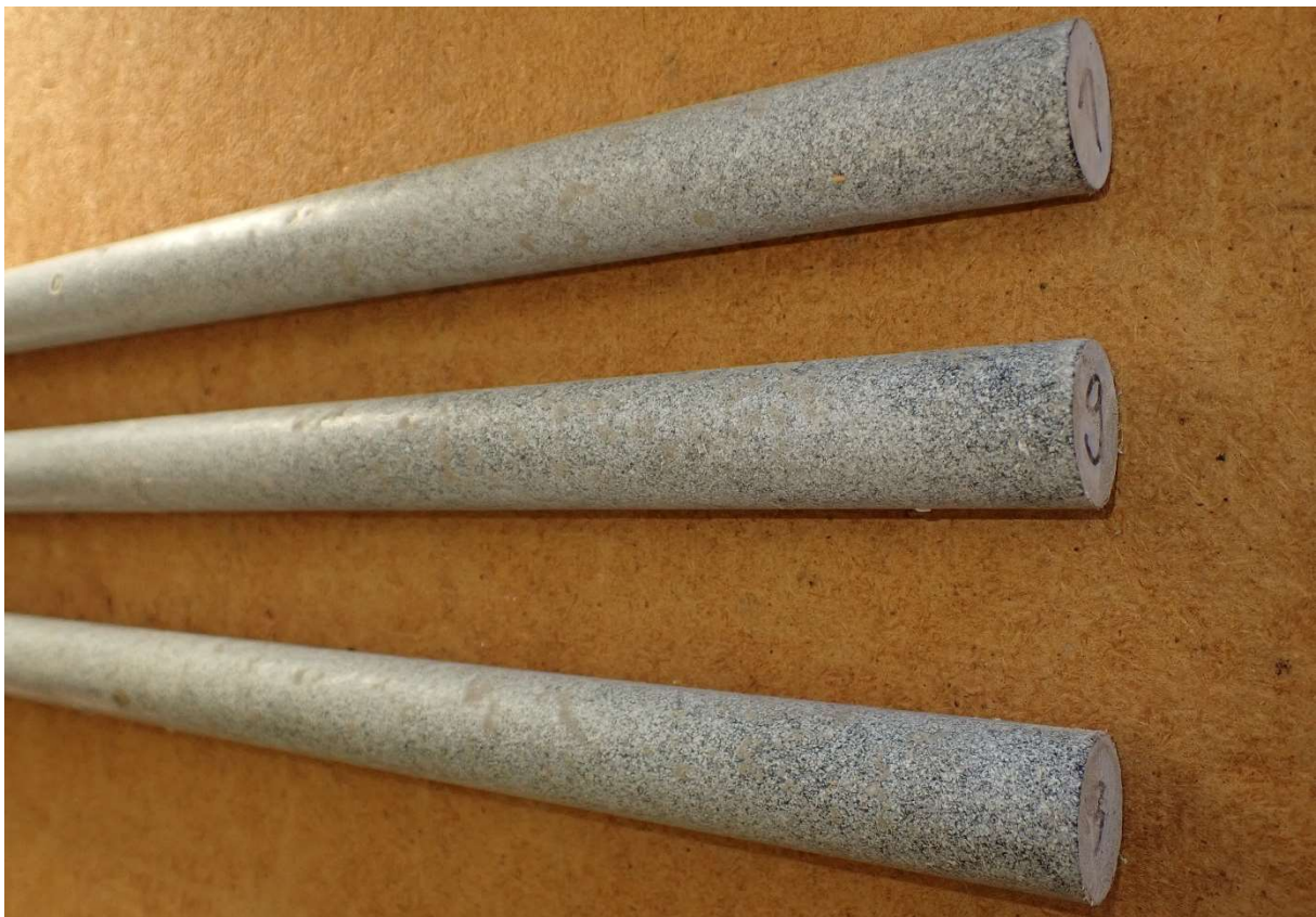
Bild 2: Ansicht der weiteren Mantelflächen der Dübel nach der Prüfung, ohne Beschädigung der Beschichtung.
