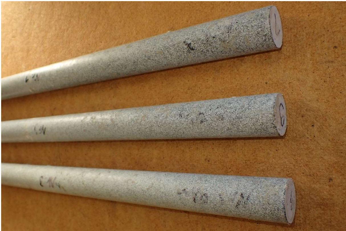
Bild 1: Geprüfte Dübel Nr. 1, Nr. 3 und Nr. 9 ohne Beschädigung oder Ablösung der Beschichtung.
